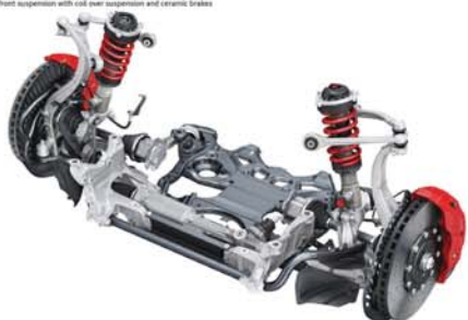
Audi RS 6 Avant GT Fünflenker-Vorderrachse mit Gewindefahrwerk und Keramikbremsen Five-link front suspension with coil-over suspension and ceramic brakes 1102
