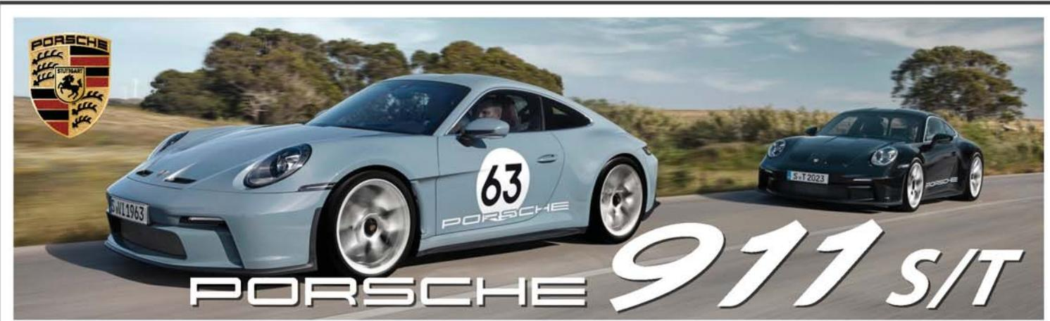
為慶祝911車系面世60周年，保時捷Weissach工程團隊設計了一款充滿高度純粹駕馭樂趣的跑車「911 S/T」，其融合了911 GT3 with Touring Package及911 GT3 RS的優點，提供獨特的敏捷性與操駕動態，搭載源自911 GT3 RS的525PS (386kW) 4.0公升自然吸氣水平對向引擎，搭配密齒比手排變速系統，再加上輕量化的車體結構，以及強化靈活性與駕駛性能的驅動裝置。911 S/T是992世代中最輕之車型，包含車輛淨重及所有液體，車重仍只有1,380公斤，選配的Heritage Design套件靈感來自於1960年代末期至1970年代初期911 S的賽車版本。
