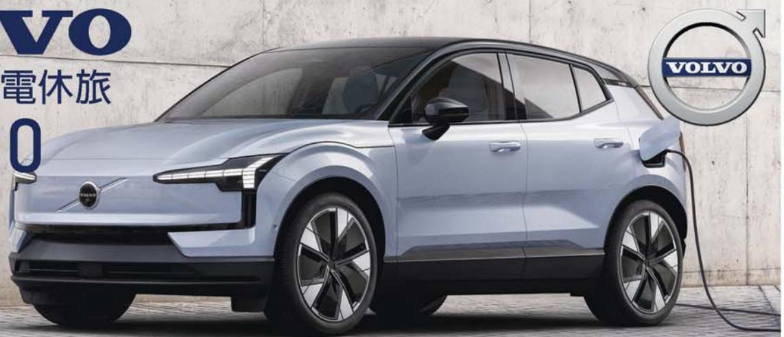
早前，VOLVO純電動小型休旅車EX30舉行了全球線上首發，此車系是該品牌有史以來最迷你的車系，也是第四款純電動車，同時也是繼 XC40 Recharge 和 C40 Recharge 兩款電動SUV之，另一款更適合城市使用且價格更實惠的車款。EX30的三維尺寸是，長4,233mm，寬1,837mm，高1,555mm，軸距2,650mm。VOLVO表示，EX30的底盤經過調整，可充分利用緊湊小巧的車身尺寸、還有相對較低的車身重心，以及理想的前後車重分配，車身淨重1,830公斤。
