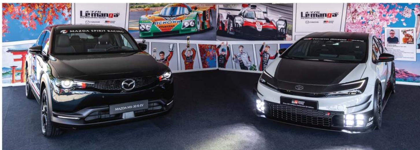
這款運動版的油電複合動力車款搭載客制化的18吋空氣動力優化的RAYS輪圈，搭配 Michelin Pilot Sport 4S 跑車胎，尺寸為 235/50R18。經過修改後的下部前進氣口現在採用蜂巢式結構，同時品牌還宣稱 GR Prius 配備「寬輪距懸掛系統」。
