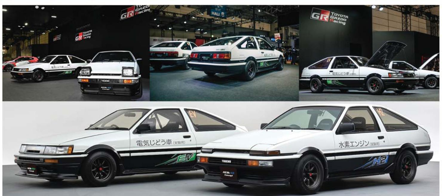
另一款AE86改裝的純電動概念車 AE86 BEV 是採用原來 AE86 Corolla Levin 車身加以改造，配備固定式車頭燈。此車具有與 AE86 H2 概念車幾乎完全相同的車身塗裝，隱藏在鈑件之下的是相當有趣的動力系統，AE86 BEV 的電池供電系統則使用來自同廠Tundra油電複合動力車型的電動馬達、以及來自Prius插電式油複合動力車型的電池模組，以及其他來自豐田和凌志（Lexus）量產車款的零組件。
