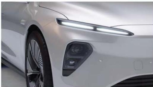
全新ES8採用智能多光束大燈，在激光雷達的支持下，結合前視攝像頭、毫米波雷達，可以自動偵測路況，指引照明系統實現精準精的光束分布；可提供多種自適應光型，適應包括低速城鎮、市區道路，中速鄉村道路，高速道路、轉彎、動態連續轉彎、會車智能遠光防眩、跟車智能遠光防眩、路標防眩在內的各種常見行車場景。EC7也配備了該款大燈。
