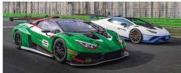
Huracán GT3 EVO2 的車身完全採用碳纖維製成，這是Huracán賽車的二度進化，換上一套改良的空氣動力學套件，採用一個全新的分流器，以增加車子後方的下壓力。Huracán GT3 EVO2 採用源自 Huracán STO 的大型尾翼，進一步為車子提供道路行駛的下壓力，同時為車子大幅強化過彎時的支撐性。
