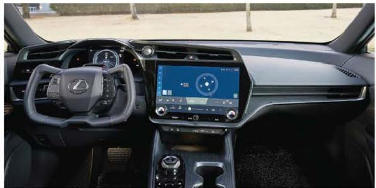
凌志RZ目前僅只有單一動力系統車型RZ450e，最大馬力312hp（前軸馬達204hp，後軸108hp），最大扭力435Nm，電池容量為71.4kWh，充滿一次電可續航超過420公里。全新RZ的車身尺碼為4805mmx1895mmx1635mm，軸距2850mm。RZ450e由於沒有內燃機也不需要冷排，因此外型具有更好的空氣動力學。RZ共有六種車身顏色選擇，當中包括Aether Metallic以及品牌全新推出的金屬塗裝Sonic Copper。此外，全車系也提供雙車色的選項（bi-tone），而紡錘式格柵到前蓋和車頂，則都是採純黑塗裝。
