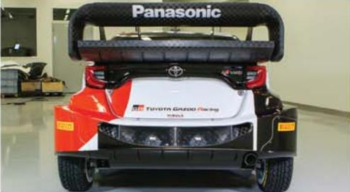
法規要求，車身也改採一些不太複雜的空氣動力套件，另外恢復機械式換檔，並移除主動中央差速器。這些變革讓車手更能展現他們的駕馭技巧，對車手來說，他們得需要適應油電合動力系統，並與工程師合作，在這些取得的新參數中來優化車子的性能和個人的駕馭技巧。自去年春天首次舉辦以來，GR YARIS Rally1 已經通過徹底的測試計劃，一直針對蒙地卡羅拉力賽的特殊需求進行測試調校，這場競賽以其多變的天候條件而聞名，路況從乾燥的瀝青到冰雪道路都有，對駕駛著全新車款的車手來說，是一固相當艱巨的挑戰。
